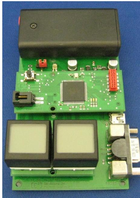
Alternativ kann auf dem DevBoard Main Board auch eine KM0008 Tastenmatrix mit Anschlüssen für acht Sxnnnn-Schalter über Flachbandkabel für den Schaltschrankbau verwendet werden.
